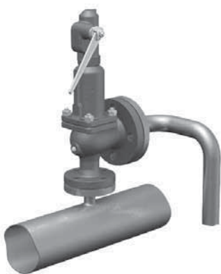
Правильная установка для воды и сж. воздуха
